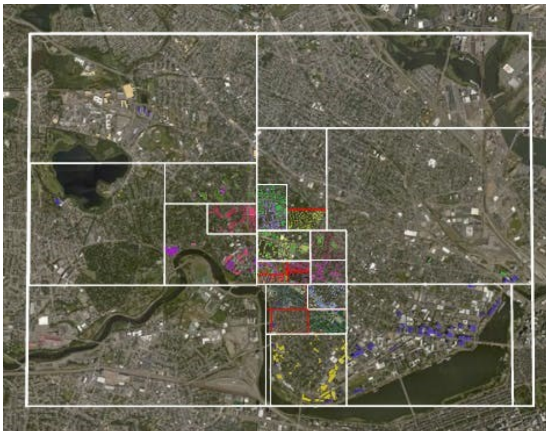
Obrázek 8: Využití adaptivního quadtree v oblasti s nerovnoměrně rozmístěnou zástavbou (Cambridge) [7]
