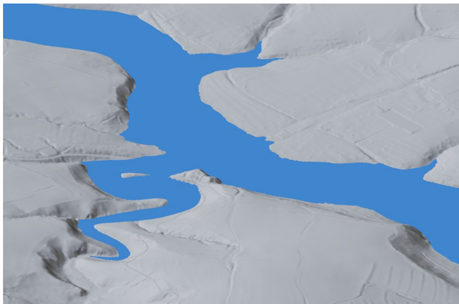
Obrázek 2: DMT se stínováním terénu a hladinou v. n. Švihov v Zahrádce, vlastní tvorba
